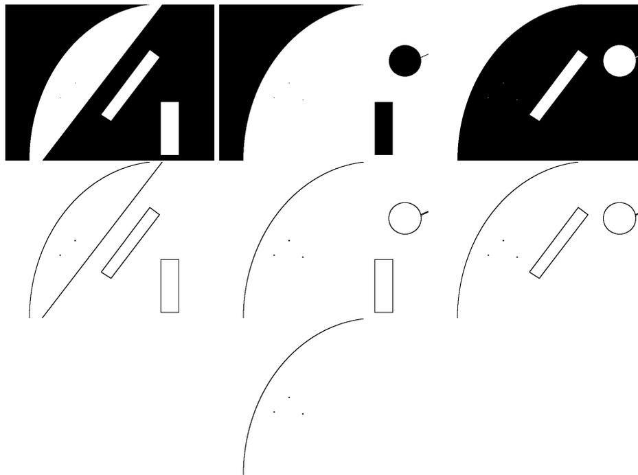
FIG. 4.7 – Détection de contours sur les bandes RVB et intersection des détections
